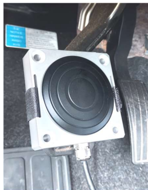
Rys. 5 Mocowanie miernika nacisku na pedale hamulca
