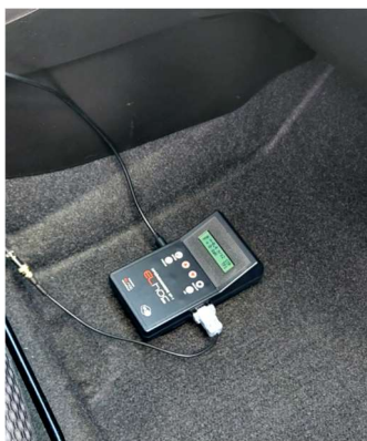
Rys. 4 Umieszczenie opóźniomierza w pojeździe
